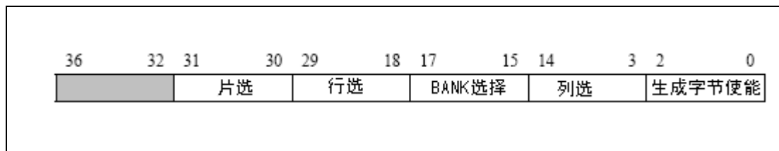
图 8-1 DDR2 SDRAM 行列地址与 CPU 物理地址的转换
