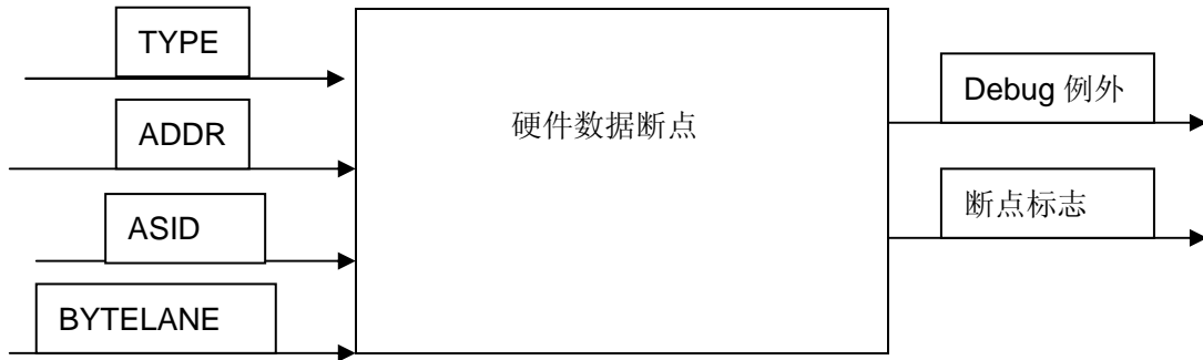
图 4-33 硬件指令、数据断点概况
